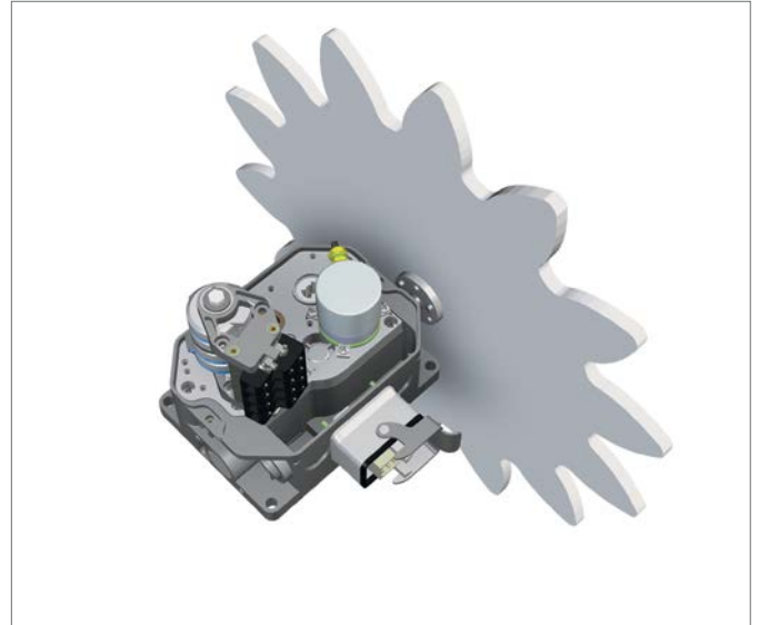
Stromag Light Cam® mit direkt angetriebenem Inkrementalgeber und verwechslungssicherem Steckverbinder
